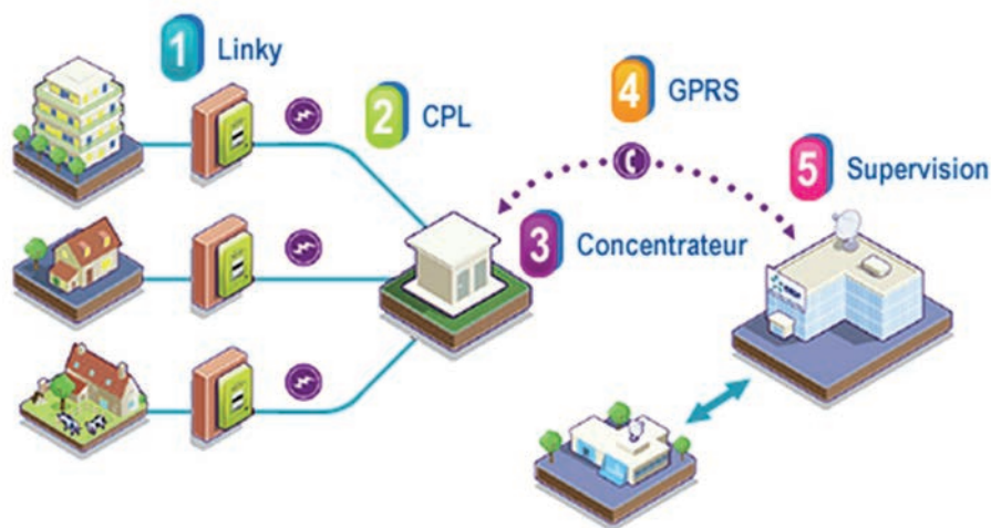
Schéma de principe d'un réseau électrique intelligent.
