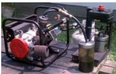
L'Evaporizor de Marcello Bartolotta monté sur un groupe électrogène de 2 kW.
